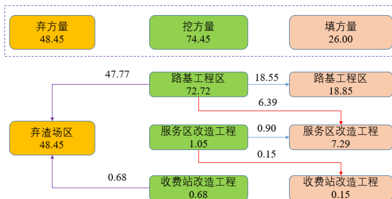
图 1.1-8 项目土石方流向图 万 m 3
